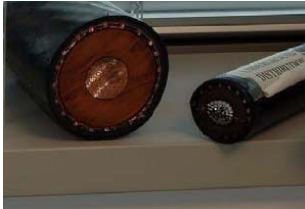
Figura 3. Cables de cobre y aluminio para líneas subterráneas de alta tensión. Figure source: PSC, Wisconsin, EEUU
