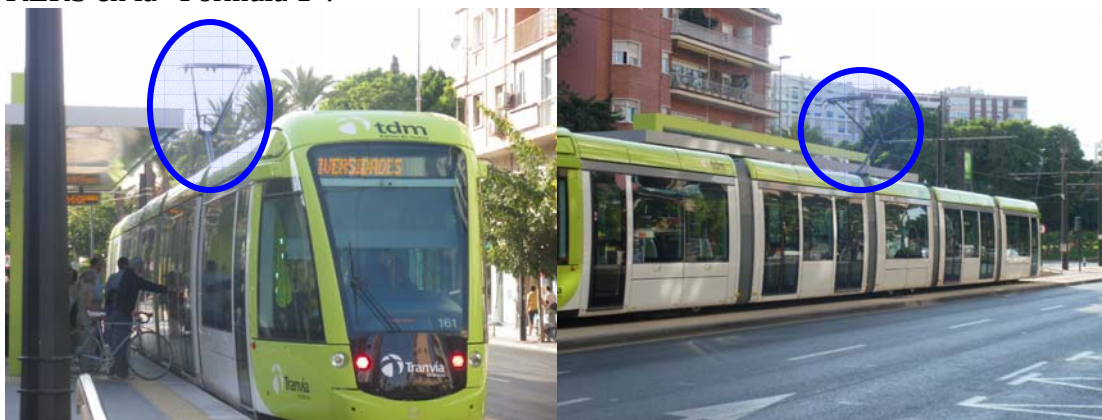
Figura 1. Tranvía tipo “citadis” y su captador de energía pantógrafo.
