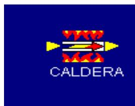
Los dos triángulos amarillos son las puertas de la caldera. Estos indican la dirección del fluido que atraviesa la caldera (en este caso hacia la derecha), y estos triángulos permiten conectar la caldera a otros componentes.
