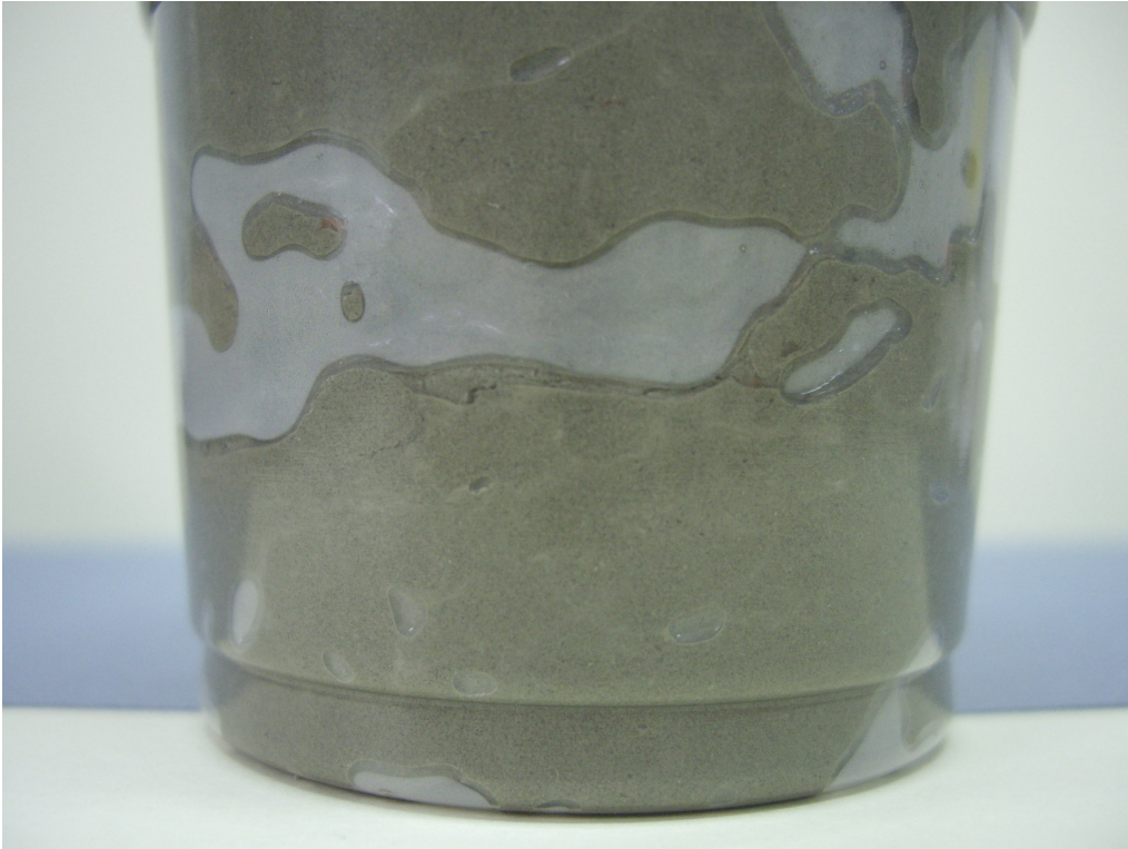
Fig. 5. Simulación de coqueras producidas en un hormigón vertido en un encofrado de plástico (vaso). Este tipo de fallos es frecuente en la puesta en obra del hormigón. Hay dos opciones para controlar este efecto; i) colocación eficiente del hormigón, ii) usar un HAC.
