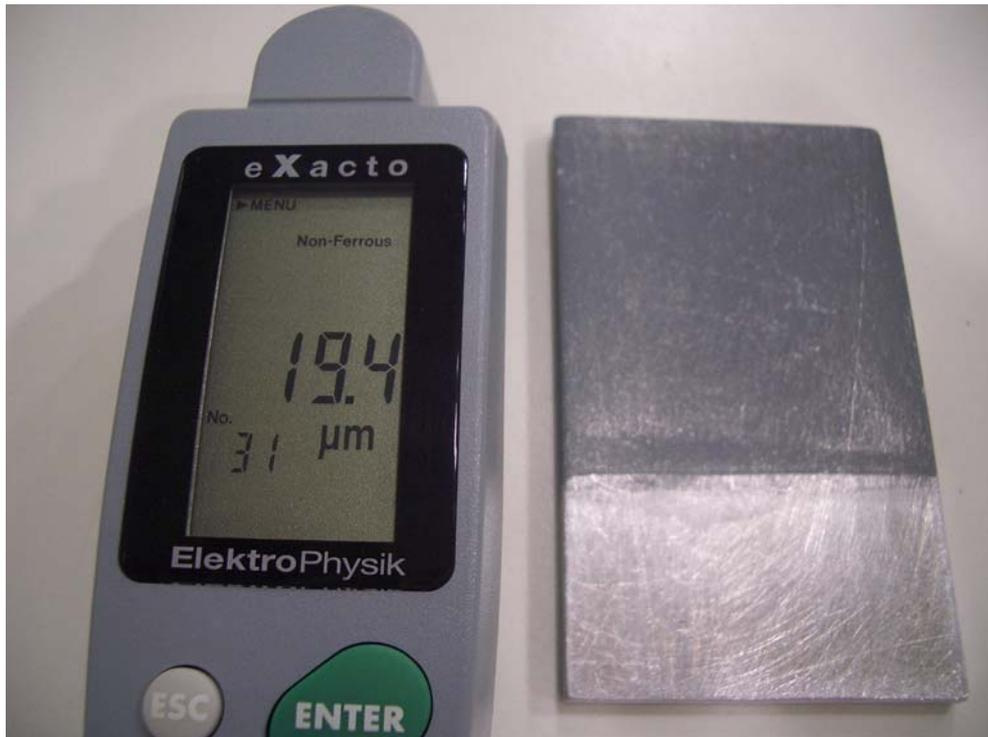
Fig. 5. Medidor de espesores (izquierda) y lámina de aluminio recubierta con zinc (galvanizado). La parte superior del electrodo de aluminio presenta un color gris (recubrimiento de zinc).
