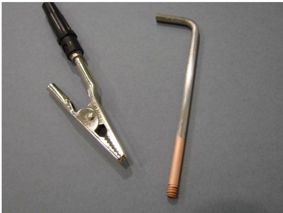
Fig. 2. Montaje de celda electrolítica para electrodeposición de cobre. Detalle de pieza recubierta.
