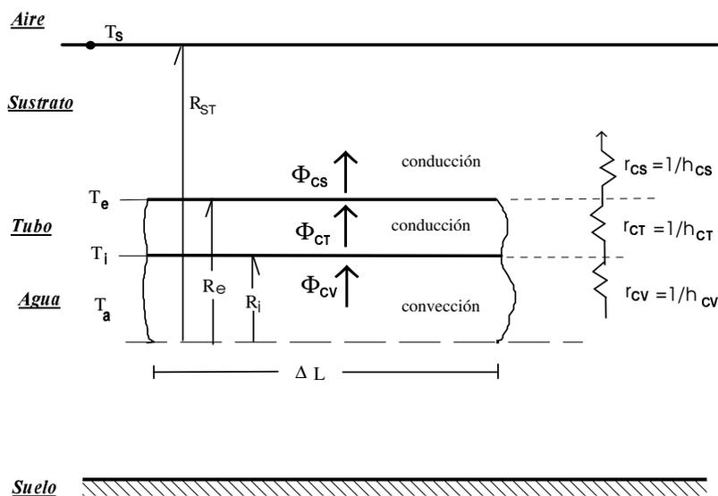
**Figura 3.** Mecanismos implicados en la transferencia de energía de un tubo enterrado en un bloque de sustrato por el que circula agua (convección al interior del tubo:  $\Phi_{cv}$ ; conducción a través de la pared del tubo y del sustrato:  $\Phi_{ct}$  y  $\Phi_{cs}$ , respectivamente) y resistencias asociadas,  $r$ , y coeficiente de intercambio de energía,  $h$ .
