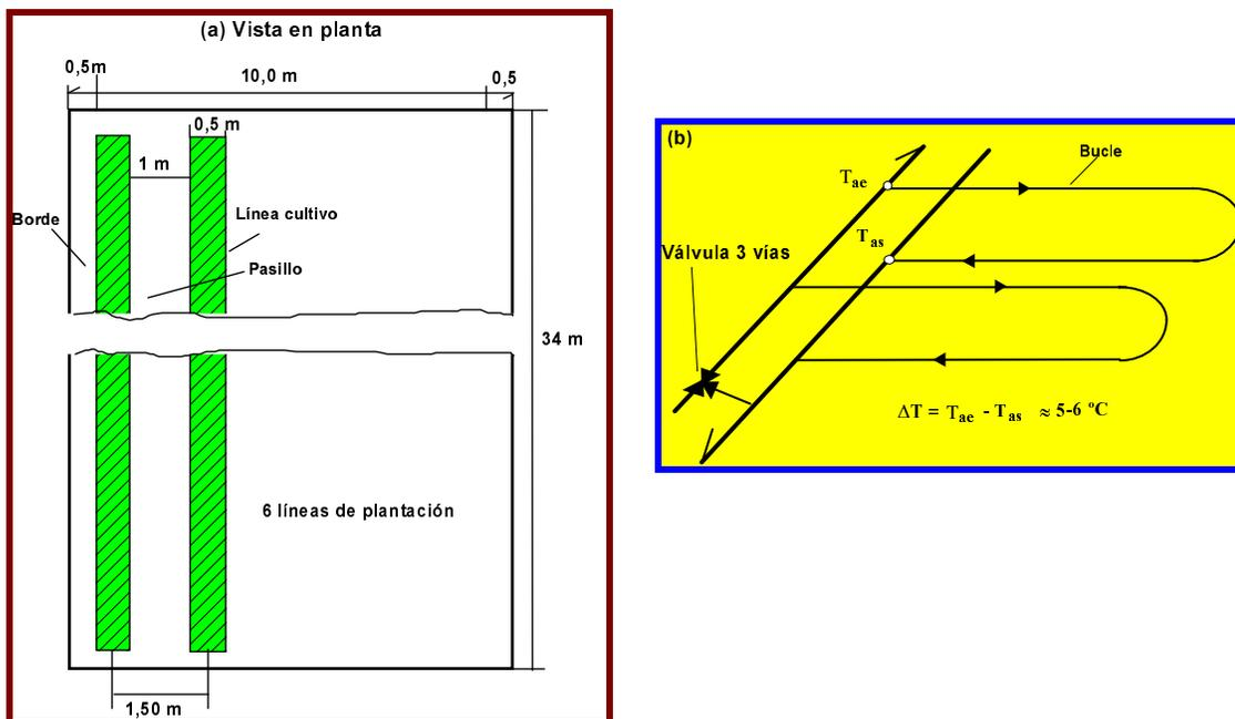
Figura 7. Vista en planta (a) de la disposición de las líneas de cultivo; (b) de la disposición de los bucles .
