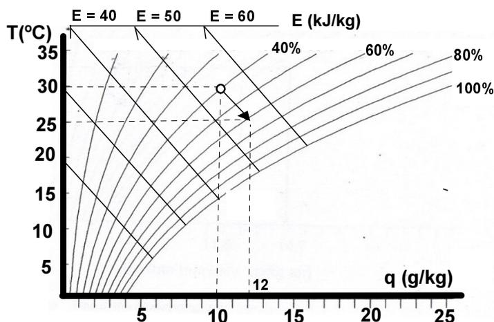
Figura 2. Representación del proceso de enfriamiento evaporativo.
