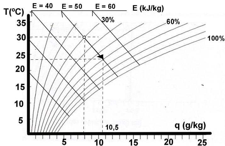
Figura 3. Representación del proceso de enfriamiento evaporativo.
