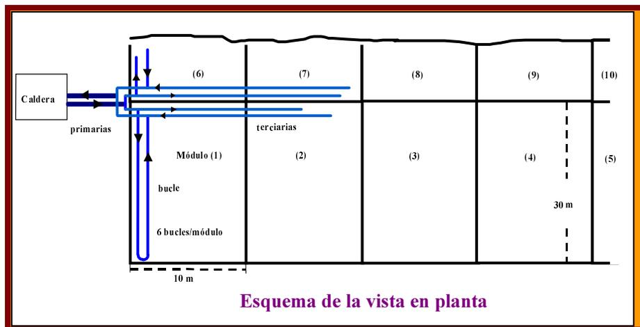
Figura 8. Vista en planta de la disposición de los bucles de tubos aéreos
