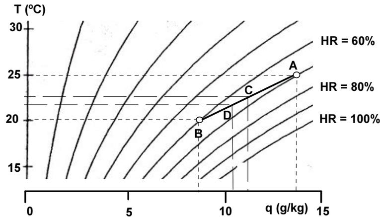
Figura 1. Representación gráfica del proceso de intercambio y de mezcla entre el aire interior y el aire exterior.
