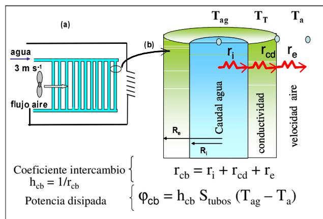
**Figura 6.** Representación esquemática de un aerotermo con tubos dispuestos en paralelo por los que circula el agua con un caudal total  $D_a = 1$  L s<sup>-1</sup>. La velocidad del flujo de aire a través de los tubos es de 3 m s<sup>-1</sup>.
