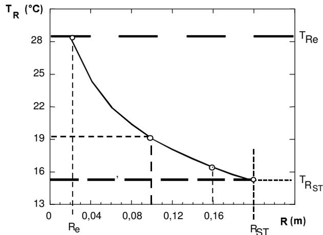
**Figura 2.** Evolución de la temperatura del sustrato a una distancia R del centro del tubo,  $T_R$ , en función de la distancia vertical (R) al tubo de calefacción (González-Real, 1998).
