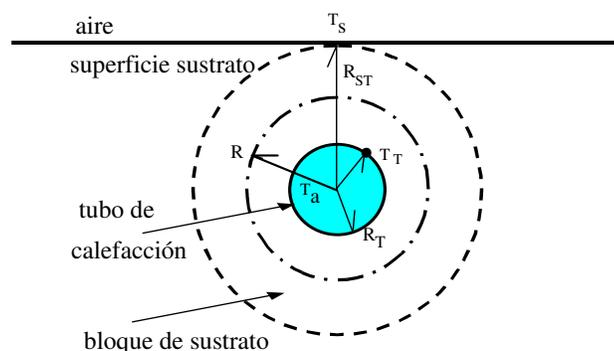
**Figura 1.** Tubo de calefacción enterrado en un bloque de sustrato (González-Real MM, 1998).
