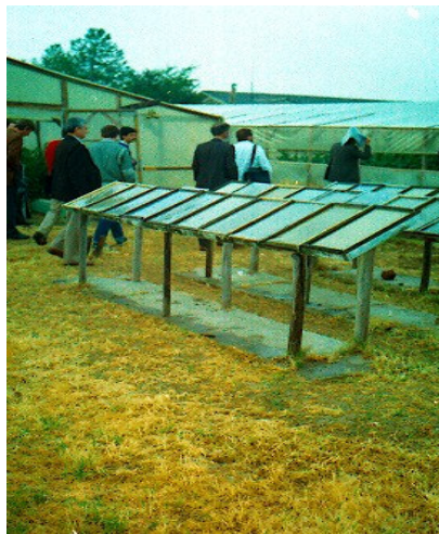
Banco de pruebas de materiales plásticos
