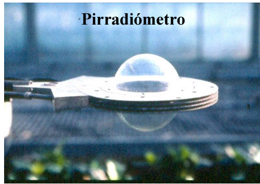
Figura 15. Vista de un pirradiómetro para la medida de la radiación neta.
