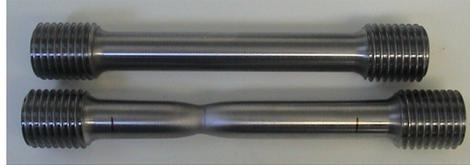
**Figura 4.3** Ensayo de tracción. Probeta antes y después de la rotura
