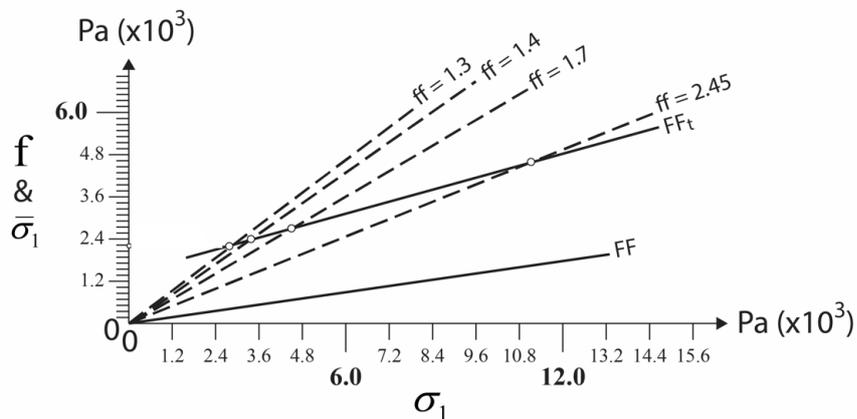
$f_{cr}$  = valores resistencia mecánica a la cizalla críticos
