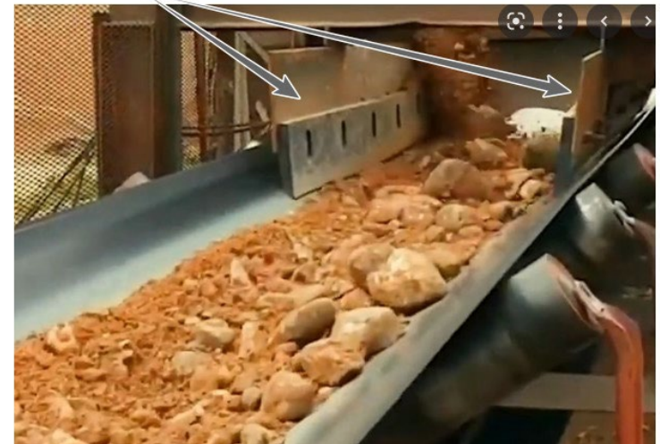
Skirting (planchas metálicas laterales o cajón colocado en el punto de alimentación)
