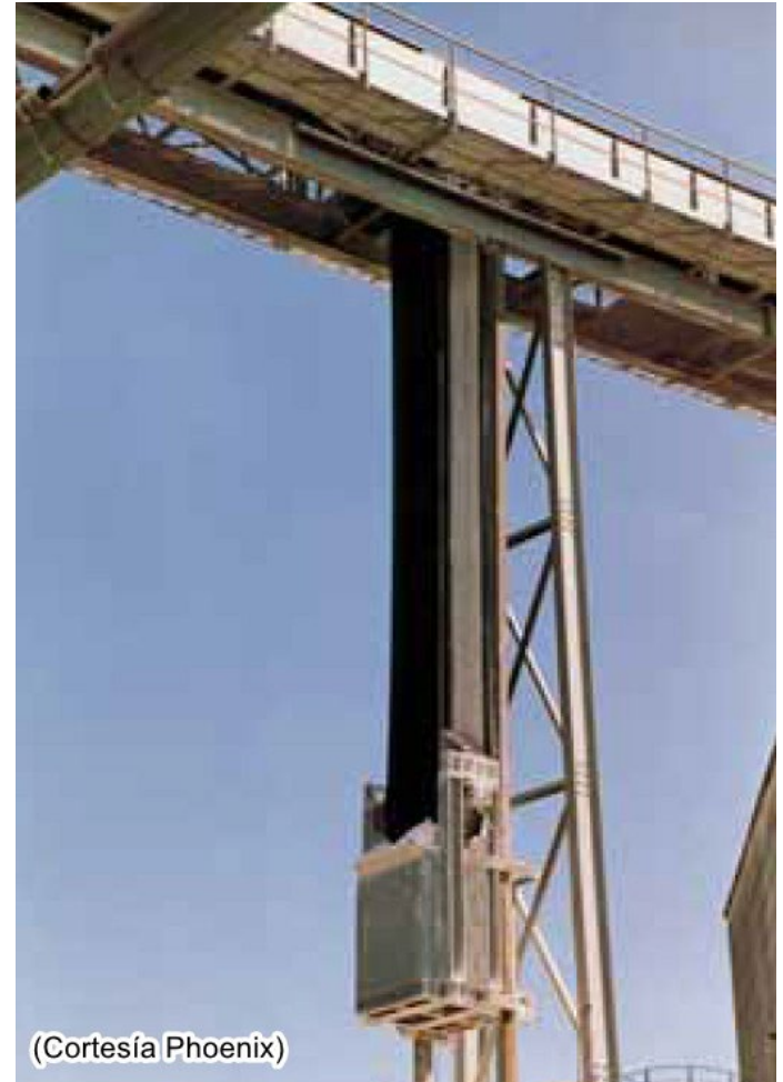
Tensado móvil con contrapeso
