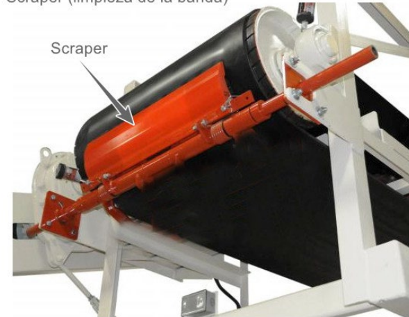
Scraper (limpieza de la banda)
