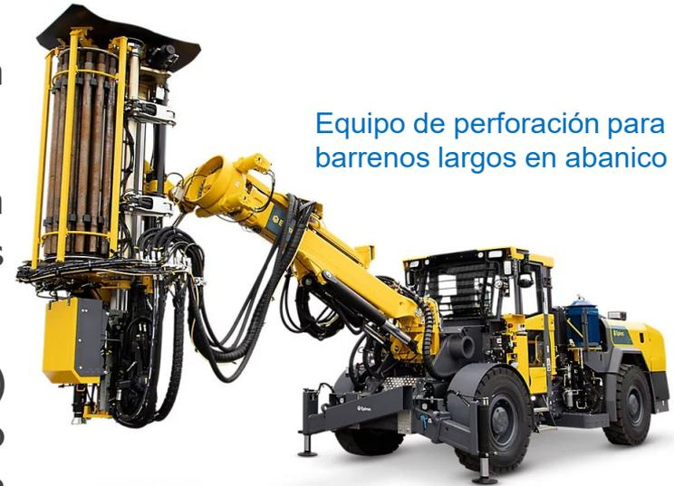
Equipo de perforación para barrenos largos en abanico
