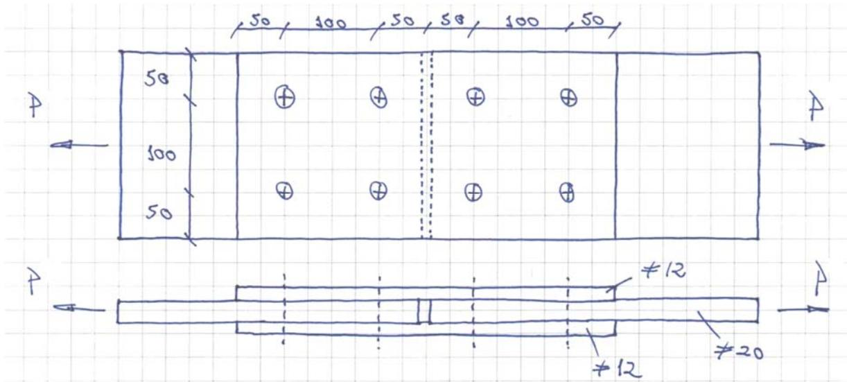
Se pide obtener los esfuerzos en los elementos de la unión.
