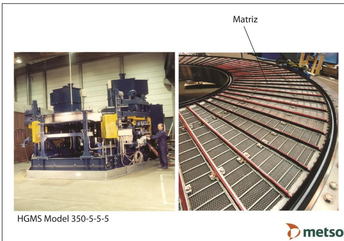
Imagen 8. Equipo HGMS modelo 350-5-5-5 con dos cabezas magnéticas y detalle del anillo giratorio con la matriz ferromagnética (cortesía Metso Minerals).
