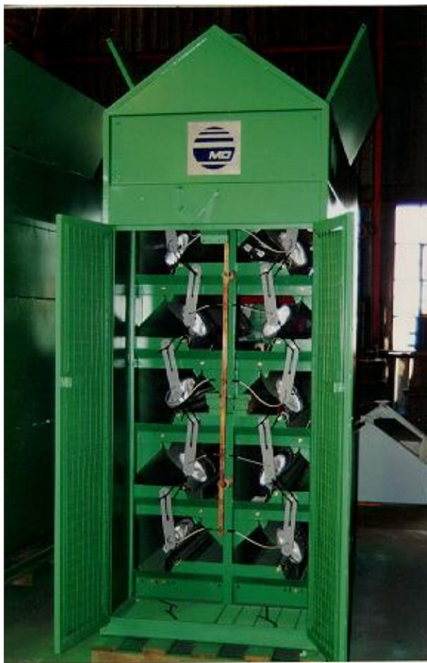
Fig. 57. Separador electrostático Carrara ES Plate multietapa (cortesía Roche Mining).
