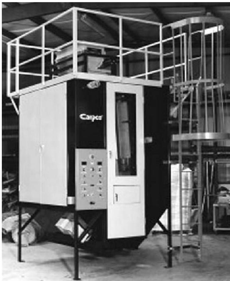
Fig. 52. Separador Triboelectrostático V-Stat (Cortesía Outokumpu Technology Inc.).
