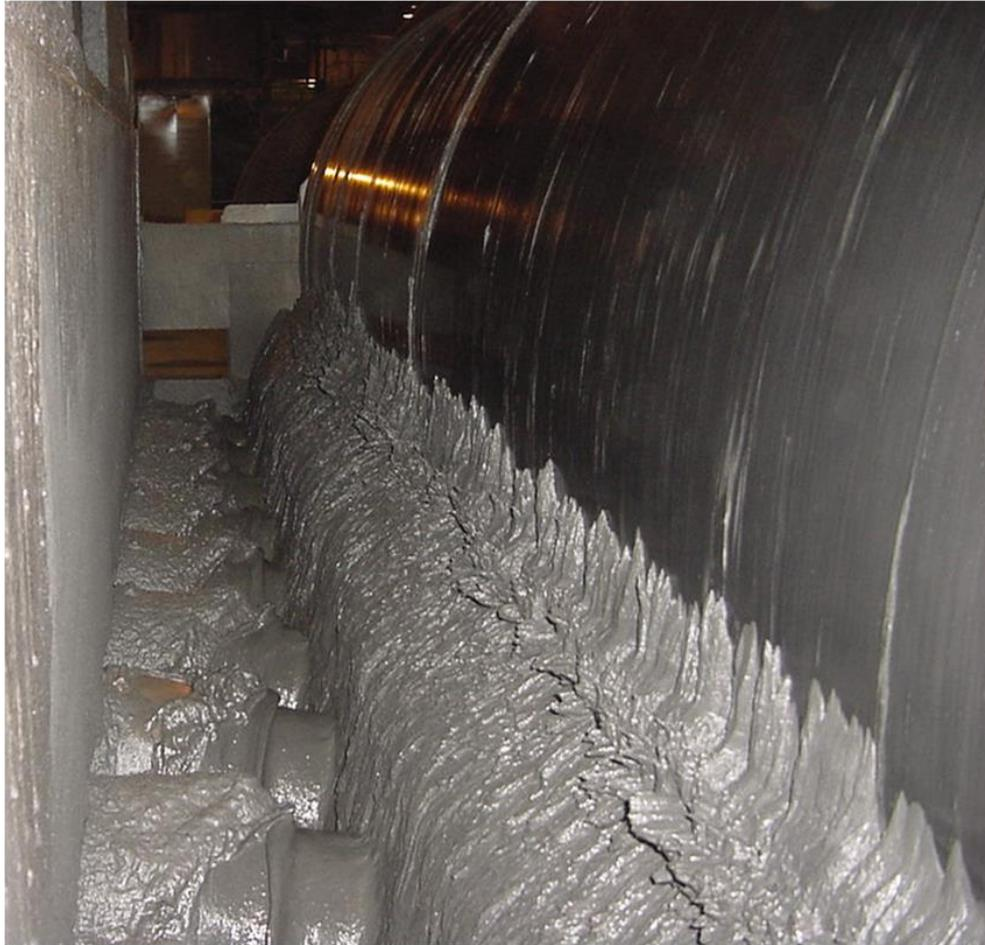
Imagen 2. Descarga del concentrado en un equipo LIMS WS1230 CR de rotación inversa (cortesía de Metso Minerals).
