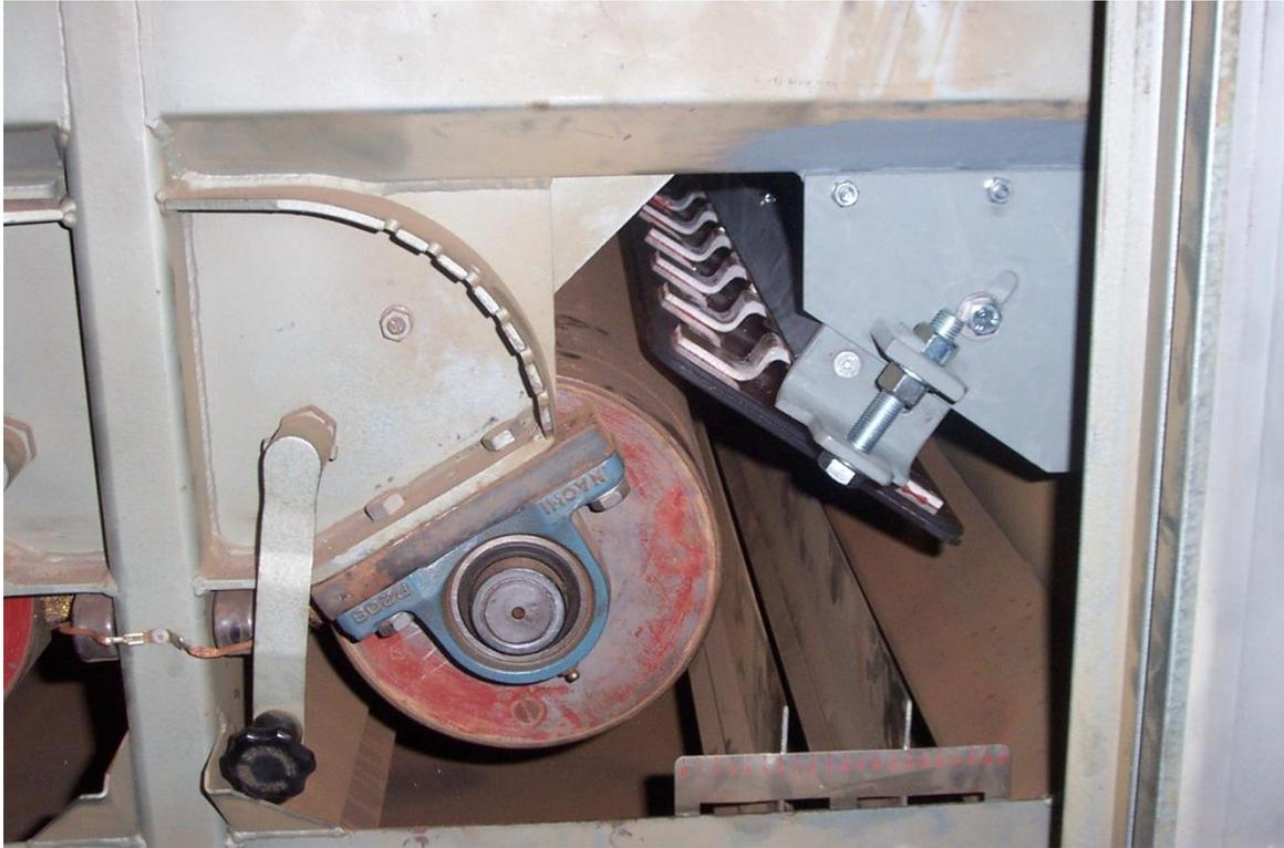
Fig. 54. Vista del rodillo y del electrodo de placa en un equipo Carrara HT Roll Retro-fit (Cortesía Roche Mining).
