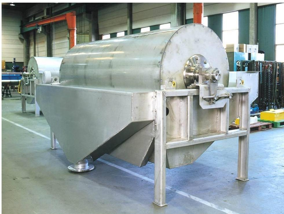
Imagen 5. Equipo *Wet LIMS WS1230DM* de Metso Minerals (cortesía Metso Minerals).
