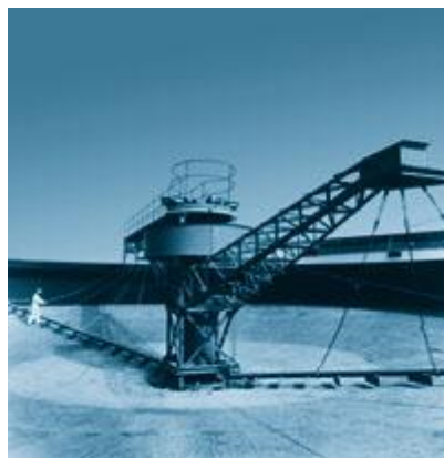
Fig.11.16: Espesador convencional de cables (Cortesía de Dorr-Oliver).
