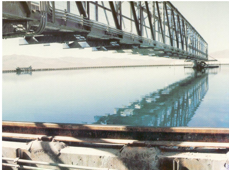
Fig.11.17: Rail periférico de un espesador de tracción (Dorr-Oliver).
