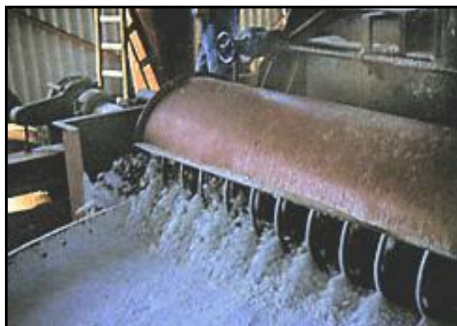
Fig.11.57: Descarga de las partículas retenidas por el filtro.
