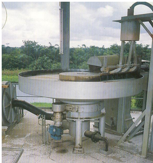
Fig.11.57: Filtro de 6 m 2 en el tratamiento de arenas para vidrio (cortesía de Dorr-Oliver).
