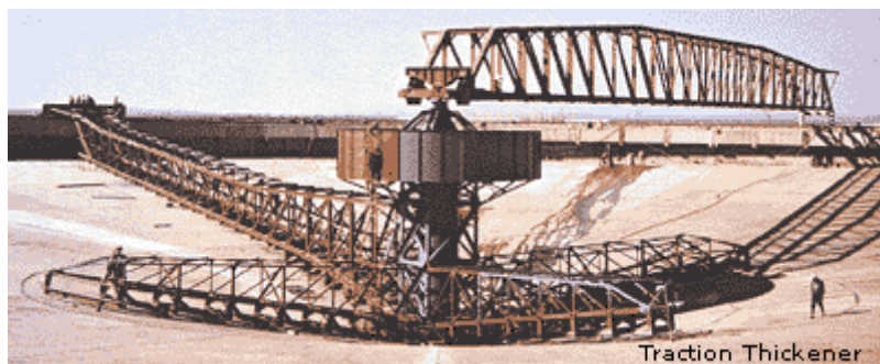
Fig.11.18: Brazos de rastrillado en un espesador de tracción (Outokumpu).
