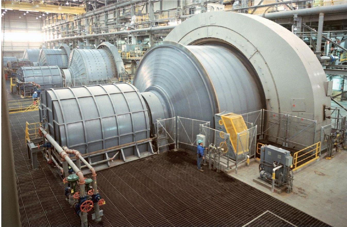
Molino SAG (Gearless) de 11 x 5.7 m, 12 MW procesando mineral de cobre en los EEUU.
