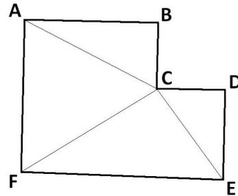
La descomposición de una parcela en triángulos puede establecerse de distintas formas. En nuestro caso, vamos a realizarla tal como se muestra en la figura adjunta. Como valor de la superficie de la parcela, daremos la suma de las áreas de los tres triángulos formados. Calcularemos la superficie de cada triángulo aplicando la fórmula de Heron.
