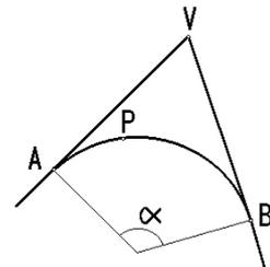
Si llamamos  $\gamma/2$  al ángulo  $\widehat{VAP}$ , el ángulo que forman los radios en A y P vale el doble, es decir,  $\gamma$ . Podemos calcular el valor de este ángulo por diferencia de los acimutes de las alineaciones A-P y A-V.
