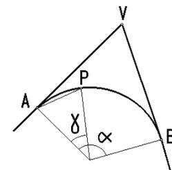
**medio de una curva circular que pasa a través del punto D, que se encuentra a una distancia de 45,72m de B y con acimut de  $\theta_B^D = 285^\circ$ . Calcula el radio de la curva y la longitud de la tangente.**
