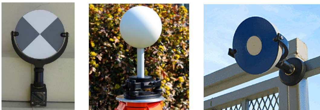
Fig. 23.4. Ejemplos de puntos de referencia (dianas) para enlazar estaciones. Las dianas esféricas no es necesario orientarlas en cada escaneo
