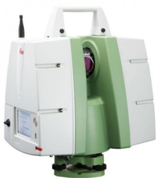
Fig. 23.2. Escáner Leica ScanStation C5 de medición de tiempo de vuelo. Alcance: 300 m. Velocidad de 50.000 puntos/segundo
