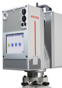
Fig. 23.3. Escáner Leica HDS 7000 de medición de fase. Alcance 150 m. Velocidad de 1.000.000 puntos/segundo
