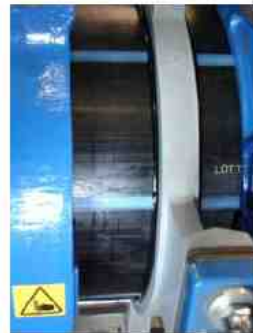
6. Calentar hasta la formación del bordón
