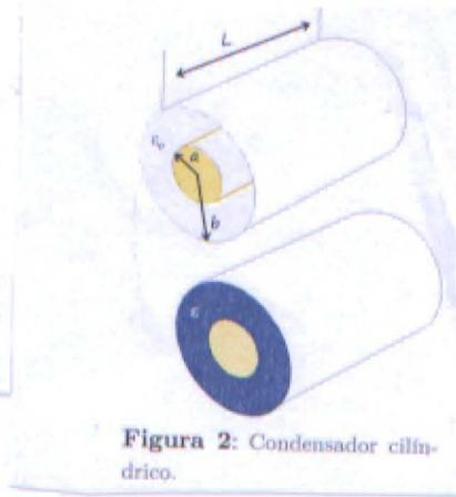
Figura 2: Condensador cilíndrico.
