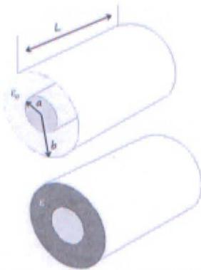
**Figura 2:** Condensador cilíndrico.
