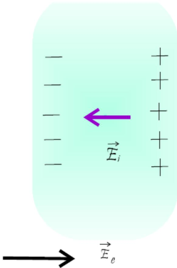
→ *No existe densidad de carga en el interior de un conductor.*
