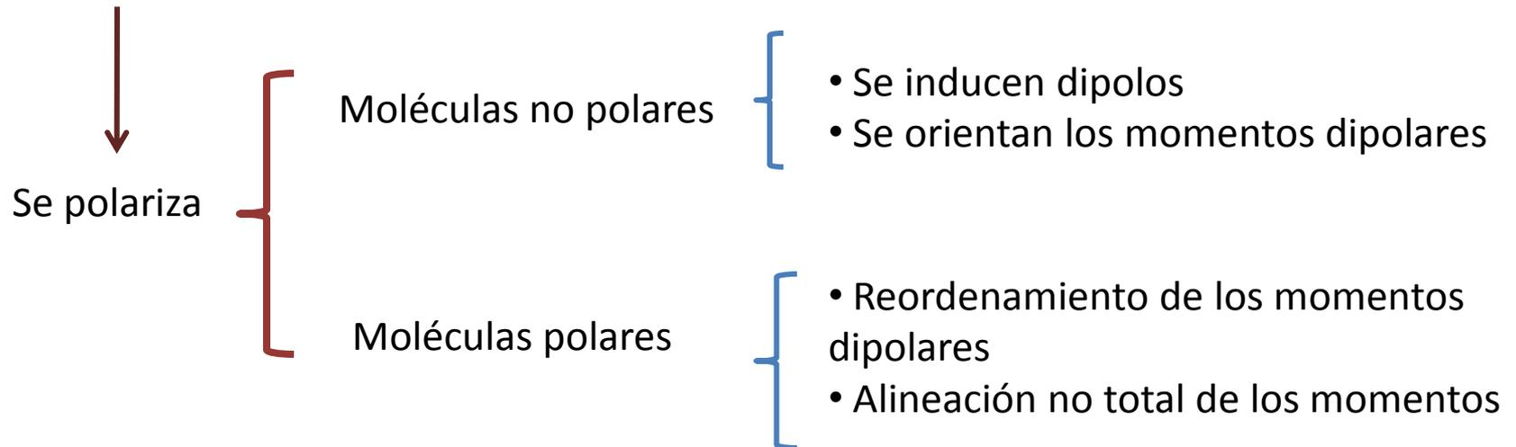
Introducimos el vector **Polarización eléctrica**, como una medida de este fenómeno y representa el momento dipolar total de las moléculas por unidad de volumen
