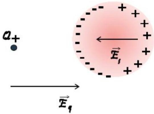
El conductor responde a la presencia de la carga puntual, moviendo sus cargas de forma que cancele el campo creado por dicha carga
