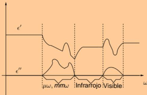
Figura: Pérdidas en función de la frecuencia
