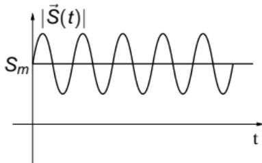
**Figura:** Variación de la potencia en función del tiempo con una frecuencia doble que los campos.
