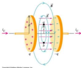
Figura: Corriente desplazamiento en condensador
