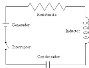
Figura: Circuito eléctrico (no depende de variables espaciales)
