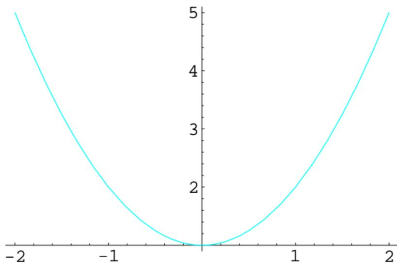
La derivada de esta función es  $g'(x) = 2x$ . Así  $g'(1) = 2$ . La recta tangente vendrá dada por  $y = 2(x - 1) + 2 = 2x$ . El valor que hemos obtenido  $g'(1) = 2$  es la derivada direccional de la función  $f(x, y)$  en el punto  $(1, -1)$  en la dirección  $(1, 0)$ . Geométricamente su significado es el que mostramos en las gráficas que siguen.
