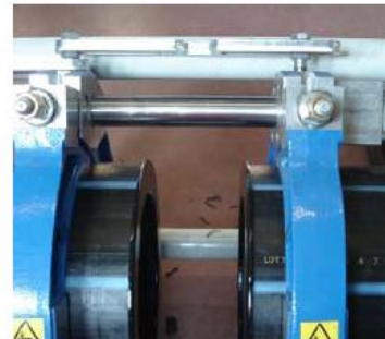
7. Abrir, quitar placa, cerrar y dar rampa de presión
