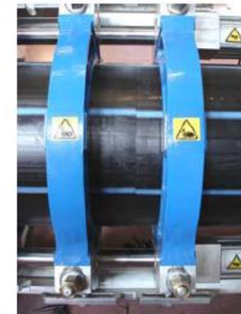
4. Comprobar alineación tubos
