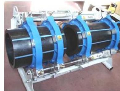
3. Eliminar virutas sin tocar con las manos la superficie refrentada
