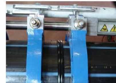
8. Dar presión de soldadura y mantener tiempo de enfriamiento
