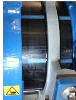
6. Calentar hasta la formación del bordón
