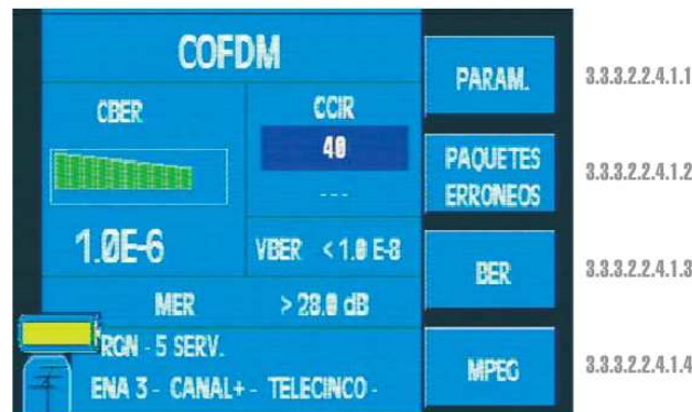
Figura 22: Medición de BER en un canal TDT antes y después de Viterbi (VBER).
