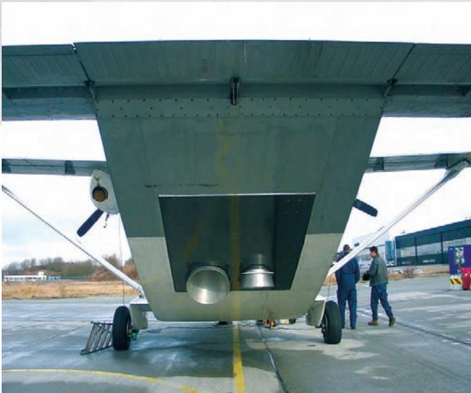
El avión 'Skyvan', perteneciente a la Universidad Tecnológica de Helsinki, Finlandia, transporta el radiómetro en banda L EMIRAD, de la Universidad Técnica de Dinamarca. La aeronave se utiliza actualmente en varias campañas de validación de la humedad del suelo en Alemania y España.
