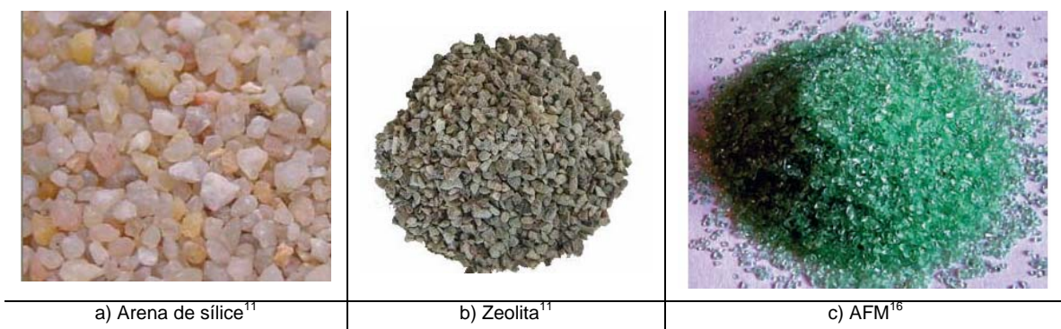
FIG. 3.14. Tipos de medios de filtrado o filtrados activos.
