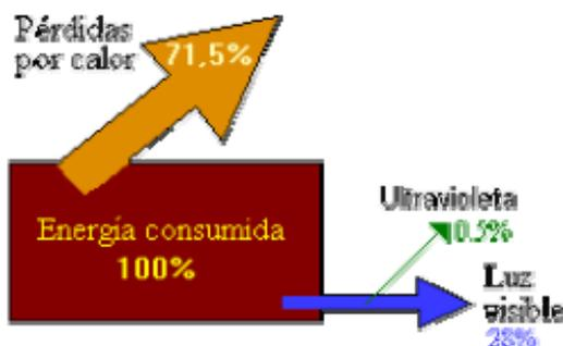
Balance energético de una lámpara fluorescente<sup>3</sup>.
