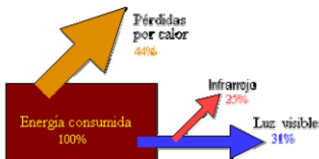
Balance energético de las lámparas de sodio de baja presión<sup>3</sup>.
