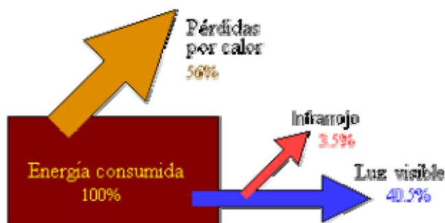
Balance energético de laslámparas de vapor de sodio de alta presión<sup>3</sup>.
