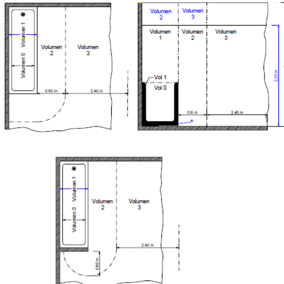
Figura 4.56: Croquis para local con bañeras y bañeras con pared de obra [2].
