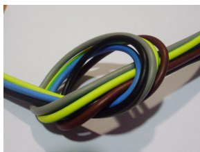
Figura 4.46: Colores para los conductores de las fases, neutro y protección.
