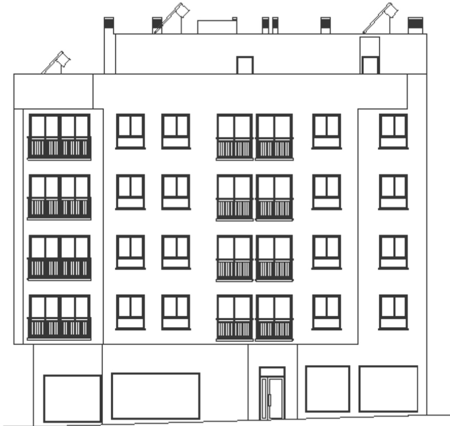
Fig. 11. Sistema de aprovechamiento de ACS por energía solar en un edificio de viviendas, con sistemas individualizados por vivienda.
