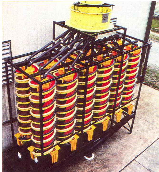
Fig.9.10: Bancada de espirales Humphreys LC3000 (Cortesía de Carpcó)
