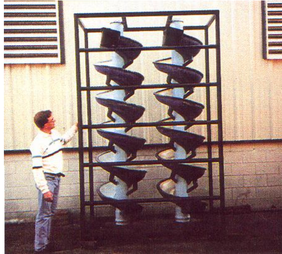
Fig.9.13: Espirales para mineral de hierro HC1800 (Cortesía de Carpcó)
