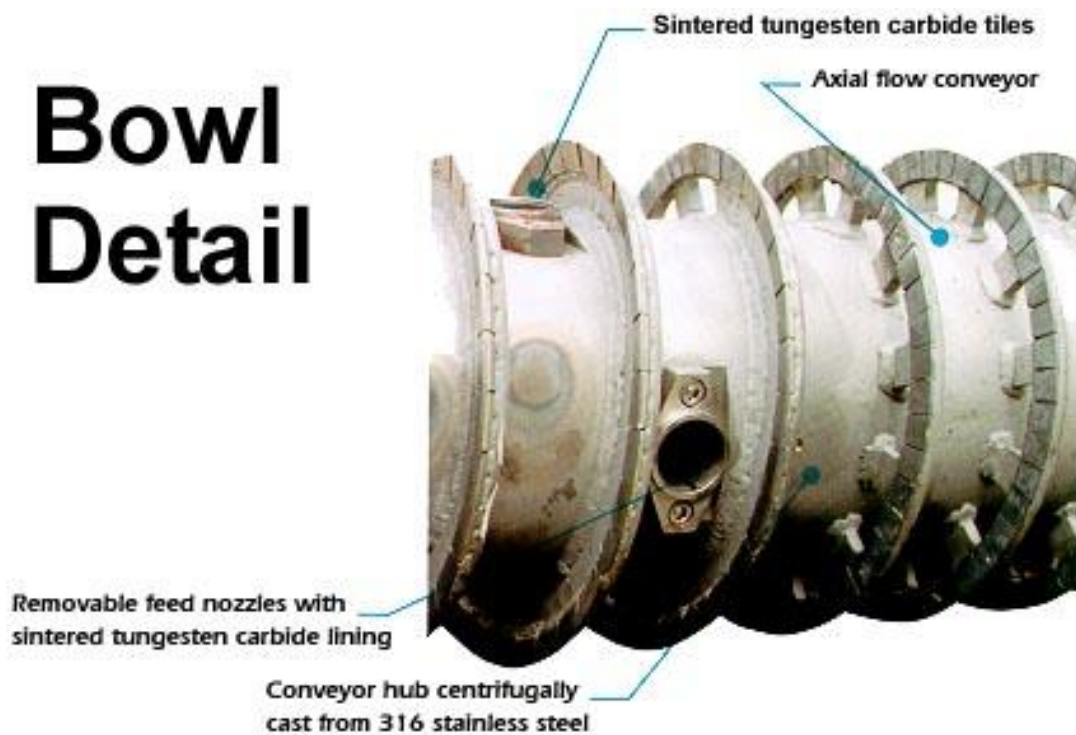
Fig. 7.27: Detalle del rotor con el tornillo adosado y las entradas de alimentación (Cortesía Andritz).
