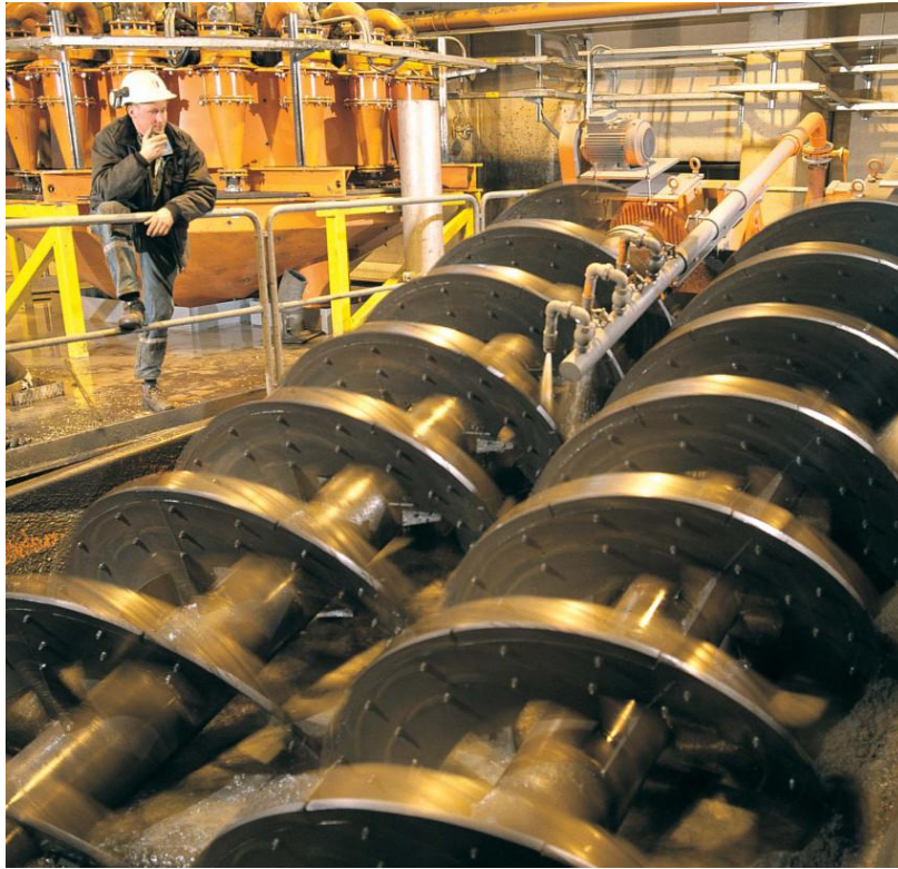
Fig. 7.10: Clasificador trabajando (Cortesía Metso Minerals - Svedala).
