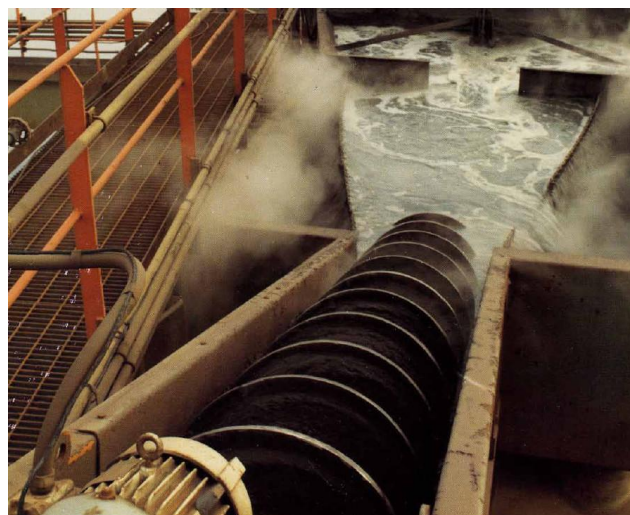
Fig. 7.9: Vista del rebosadero de un clasificador de tornillo (Cortesía F.L. Smidth - Wemco).
