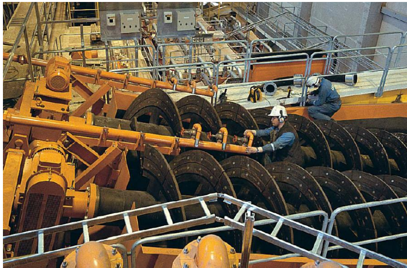
Fig. 7.10: Clasificador trabajando (Cortesía Metso Minerals - Svedala).
