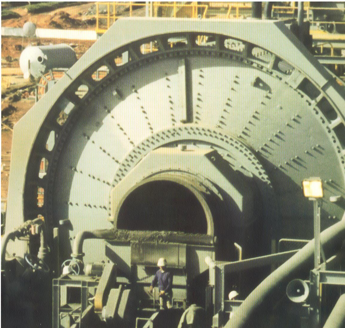
Fig. 5.8: Molino SAG (Morgardshammar) estilo Norteamericano (Cortesía Nordberg).
