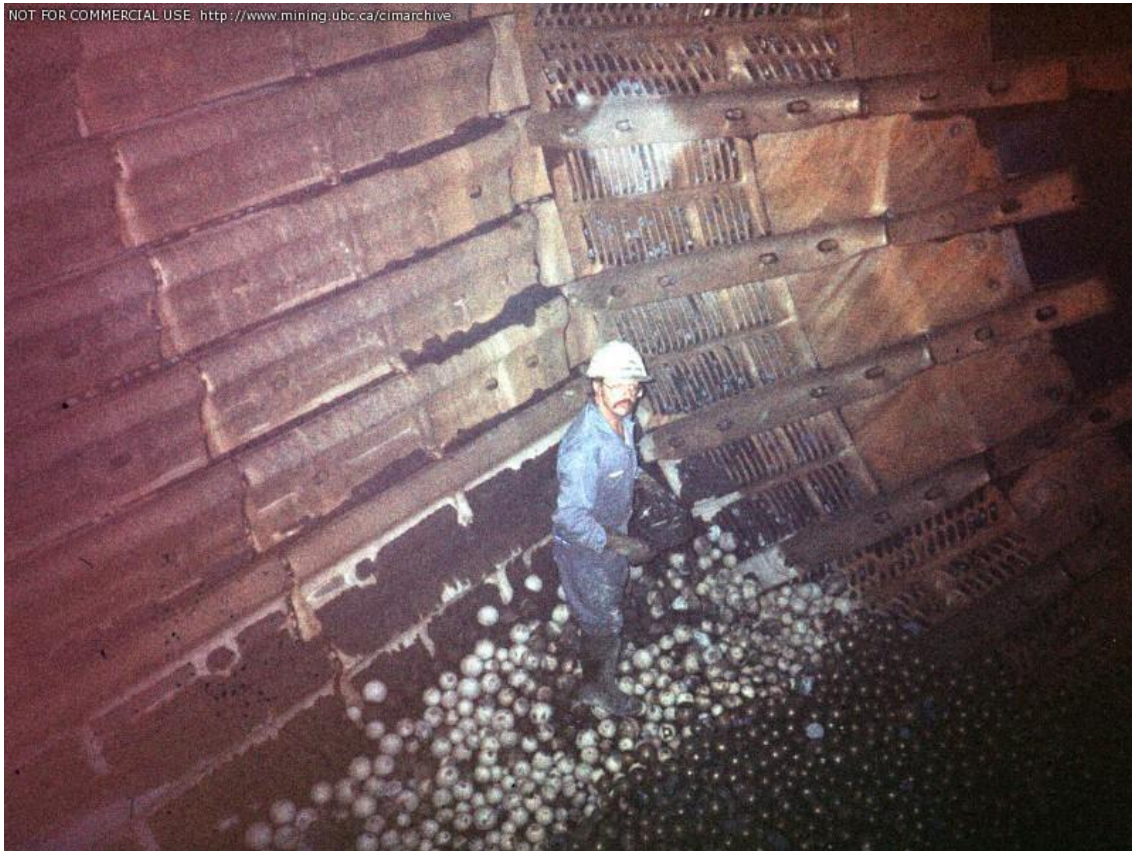
Fig. 4.18: Interior de un molino de bolas (Fuente: www.mining.ubc.ca ).
