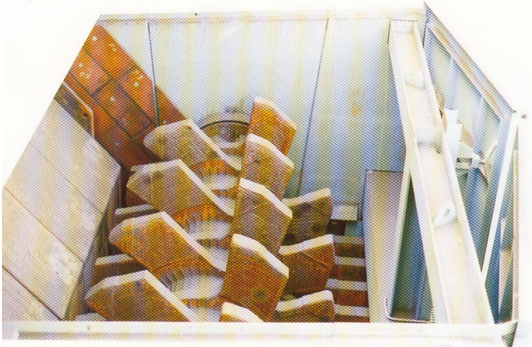
Fig. 3.61: Triturador de cilindro dentado (cortesía de Aubema)
