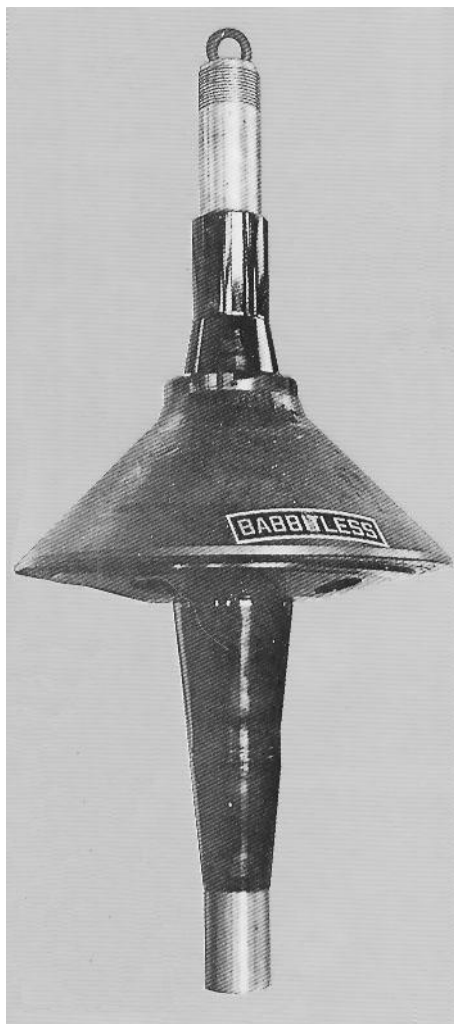
Fig. 3.28: Cono y eje principal de un triturador giratorio secundario (Cortesía de Babbitless).
