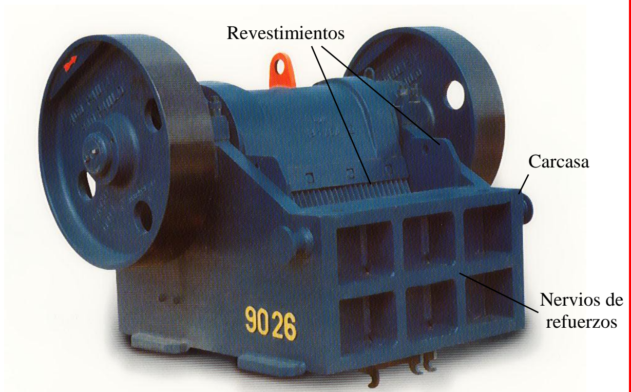
Fig. 3.11: Trituradora de Simple Efecto (cortesía de Svedala).
