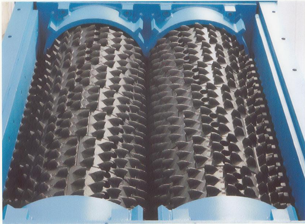
Fig. 3.41: Triturador de cilindros dentados (Cortesía de Krupp Fördertechnik).
