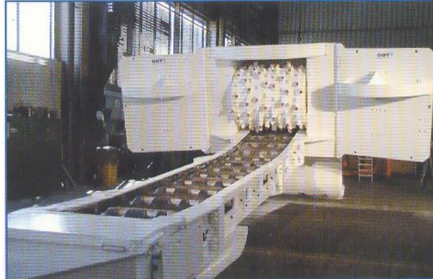
Fig. 3.59: Triturador de cilindro y transportador de racletas. (Cortesía de Mackina-Westfalia)
