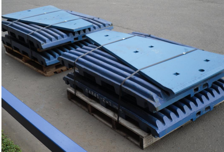
Fig. 3.3: Piezas antidesgaste y de mandíbula de una trituradora (Fuente: www.qmsupplies.co.uk ).
